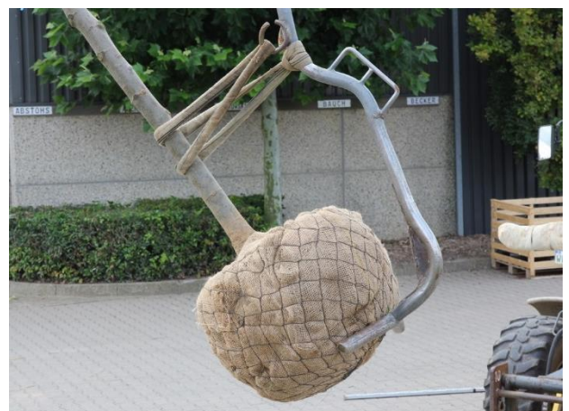
Abbildung 2: Vorsichtiges Abladen durch Anheben des Baumes mit einer Spießspinne, Bildquelle: LKSH
